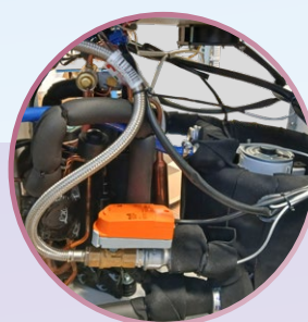
Optioneel systeem met elektronische pressostatische klep – Fintek-octrooi met algoritme voor aanpassing aan verschillende inkomende watertemperaturen en maximaal energiebesparing
