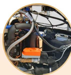
Sistema opcional con válvula presostática electrónica: Patente Fintek con un algoritmo de programación que se adapta a las distintas temperaturas del agua de entrada, maximizando el ahorro energético.
