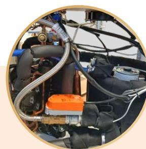
**Système optionnel avec valve pressostatique électronique** Brevet Fintek avec algorithme de programmation pour les différentes températures d'eau en entrée et économie **maximale**.
