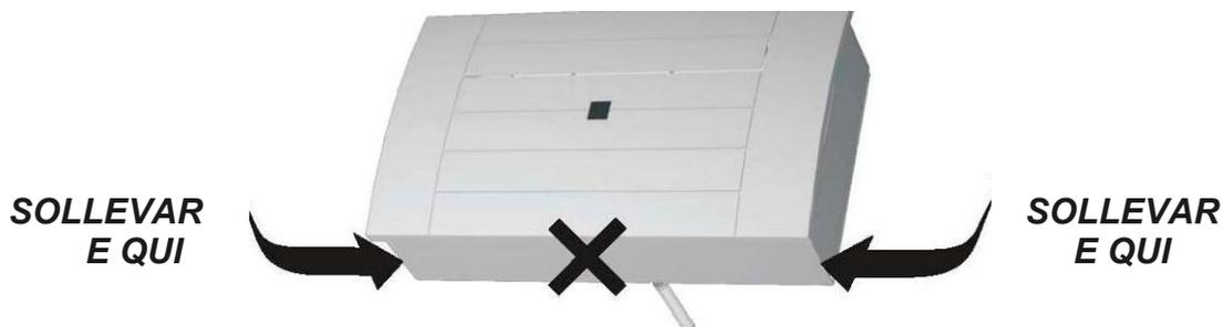
Inclinare leggermente l'unità per facilitare l'operazione di aggancio al supporto a muro. L'unità è provvista di tubo di drenaggio della condensa da agganciare al tubo di scarico che fuoriesce in basso, dal retro dell'unità : il tubo va inserito come descritto al paragrafo 2.5 e fatto passare attraverso il foro di diametro 30mm praticato precedentemente nel muro.
