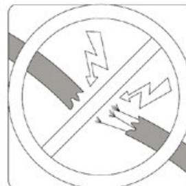
Controllare i cavi
