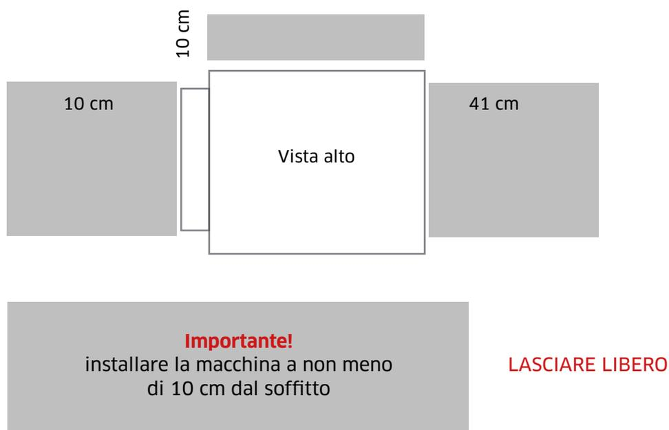
Durante la fase di preparazione è molto importante scegliere un posizionamento che permetta una agevole manutenzione.
